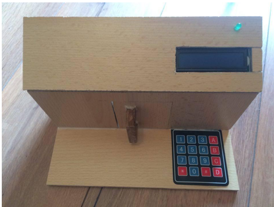
Slika 19. Slika gotove makete Arduino elektroničke brave
